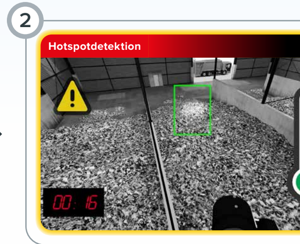
Der Schmelbrand wird im Wärmebild sehr früh erkannt und farblich hervorgehoben
